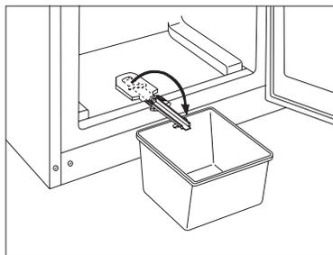
După încheierea operațiunii de dezghețare, reintroduceți elementul pentru drenare în poziția sa inițială.
